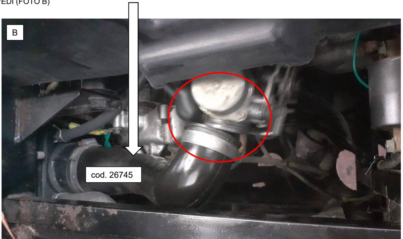
SE IL VECCHIO COLLETTORE TRA CARBURATORE E CASSA FILTRO (cod. 26745 della foto B ) NON ARRIVA A FARE COMBACIARE GLI IMBOCCHI , SARA' NECESSARIO SOSTITUIRLO , CON IL MODELLO AGGIORNATO **cod . 27400** (FOTO C)
